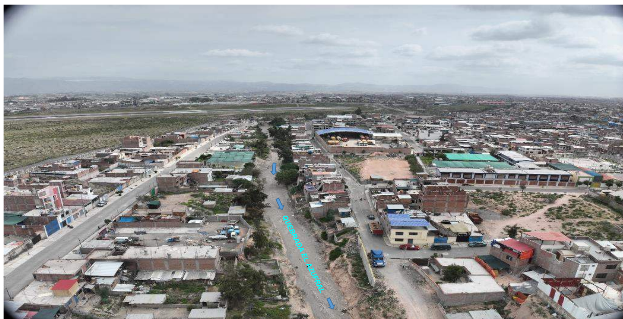
IMAGEN 03: EN ESTE TRAMO, A TRAVÉS DE LA VISTA DE DRON, SE OBSERVA LA TRAYECTORIA DE LA QUEBRADA EL AZUFRAL; AGUAS ABAJO Y VIVIENDAS CERCANAS A LA QUEBRADA, Y SU CAUCE SE ENCUENTRA COLMATADO.
